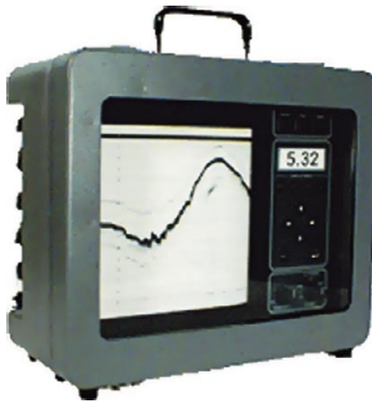
Ecoscandaglio idrografico Odom Hydrotrac
