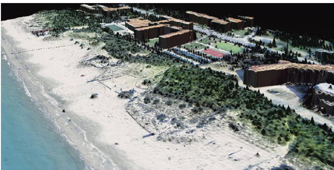
DEM con sovrapposizione (georiferimento differenziale) dell'immagine RGB acquisita con fotocamera digitale
