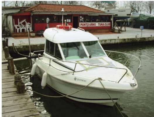
Imbarcazione utilizzata per il rilievo Multibeam della costa pisana. Si nota sulla sinistra il palo del trasduttore
